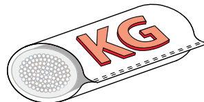
Маркировка грузоподъемности вплетена в чехол
