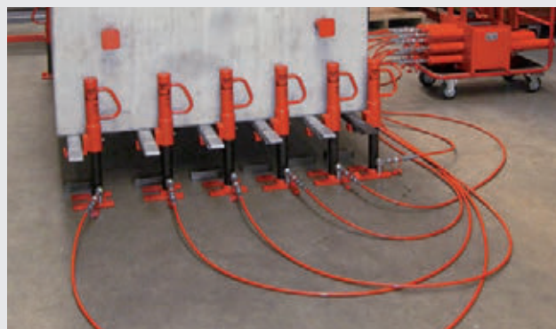
Sonderdruckblock zum synchronen Anheben mit 12 Hebeegeräten Customised solution pressure block for lifting with 12 jacks
