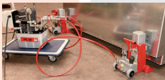
Elektropumpe JPE 30 NVR mit 2 Hebegeräten im Einsatz
